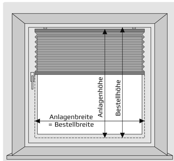
*Hinweis:* Bei der Montage mit Klemmträgern ist die Bestellhöhe = Fensterflügelhöhe.
